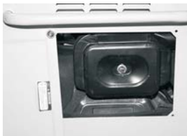
Figura 9 - Sostituzione del filtro d'aria
