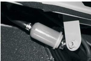
(Figura A - Sostituzione del filtro di carburante, situato dietro il pannello di accesso anteriore, una volta all'anno)
