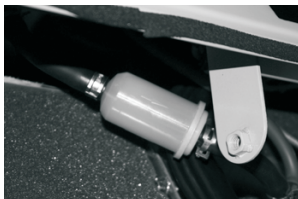
(A ábra - Évente egyszer cserélje ki az elülső hozzáférési panel belsejében található üzemanyagyszűrőt)
