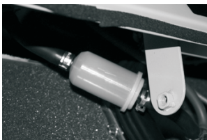
(Рисуника А - Смяна на горивен филтър, разположен вътре в предния панел за достъп, веднъж годишно)
